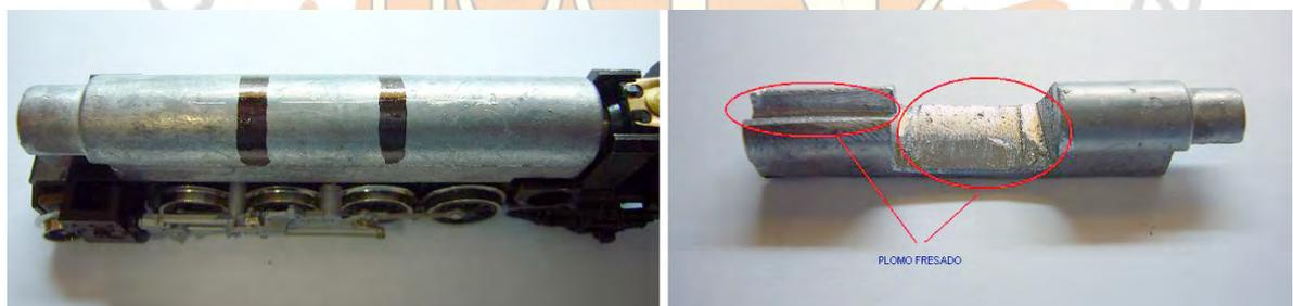
Vamos a mecanizar el chasis para poder coger tensión de este para la alimentación del deco, haremos dos orificios en las dos lengüetas que anteriormente iba alojado el motor, cuidado, tomar como referencia de medida del orificio que se muestra en la foto porque a la hora de la colocación del motor, nos puede molestar la soldadura o los cables.
