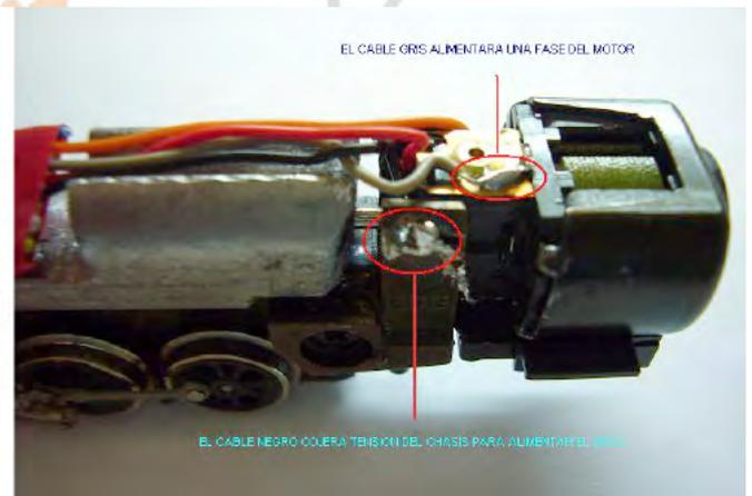
El resultado final de la digitalización de la maquina se aprecia en la siguiente imagen, se aprecia que los cables deben de ir muy juntos para que a la hora de cerrar el chasis con la carcasa no halla ningún problema.
