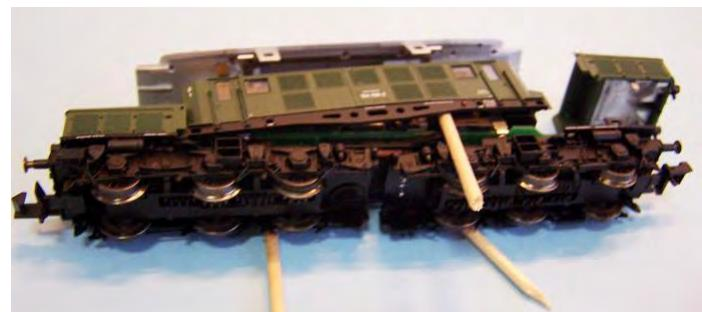
A continuación quitaremos el dummy que lleva la maquina conectado en el conector NEM 651. Mediremos la largura que debemos de dejar de cable en el deco para que este pueda ser alojado en el techo, conectador al conector nem y que no sobre cable.
