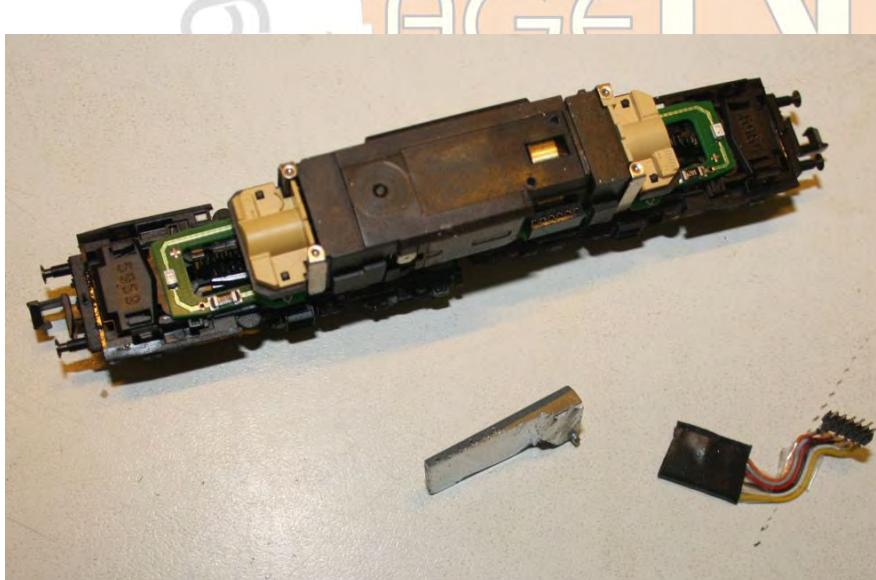
Cortaremos los cables y los volveremos a soldar sobre el conector para la conexión del deco y fresaremos el contrapeso, teniendo en cuenta de que lleva dos pequeños tetones de ajuste, intentando respetar uno de ellos.
